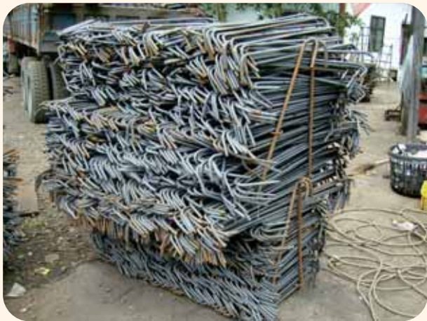
■ 傳統施工工法，柱箍繫筋組件眾多，綁紮繁複，施工品質控管不易，疏漏時造成耐震圍束力不足。
