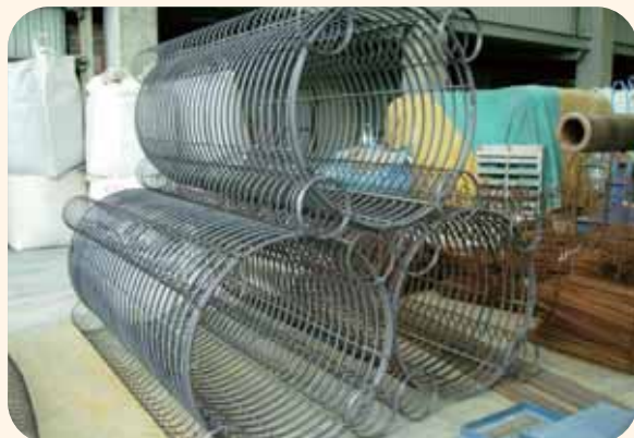
■ 預鑄柱之鋼筋專利工法預組完成 - 潤弘精密。
